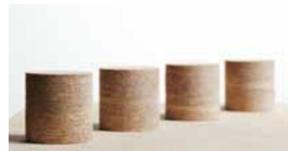
Неповрежденные цилиндры из камня Mammutti в охлажденном виде. Изменение цвета цилиндров вызвано видоизменением магнезита в периклазе при температуре свыше 500 °C.
