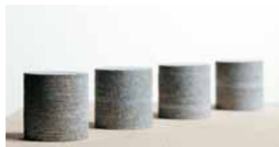
Цилиндры из камня Mammutti, высушенные при температуре 110 °C.
